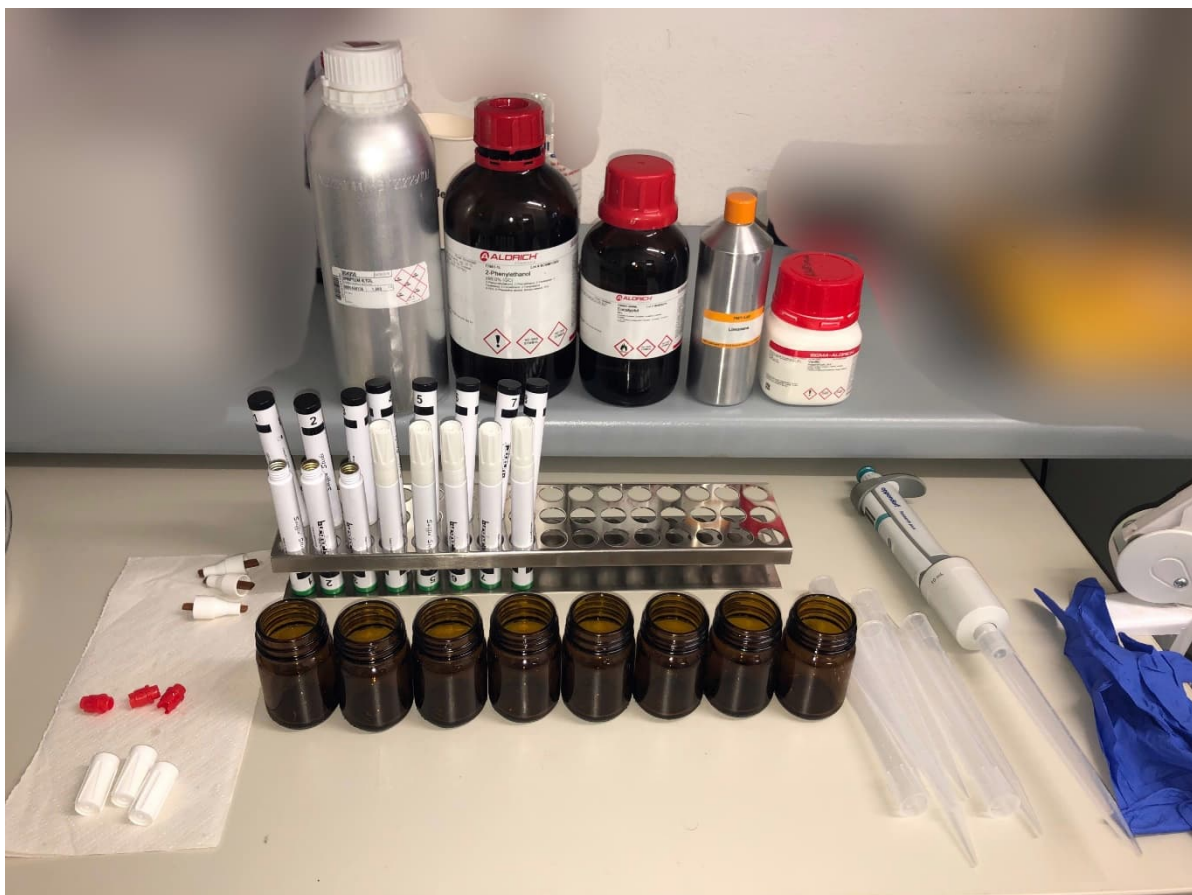
Abbildung 4: Laboraufbau zur Herstellung der Sniffin' Sticks: oben verwendete Chemikalien, mittig die verwendeten, zum Teil geöffneten, zum Teil befüllten Sniffin Sticks, unten und rechts das Equipment zum Befüllen
