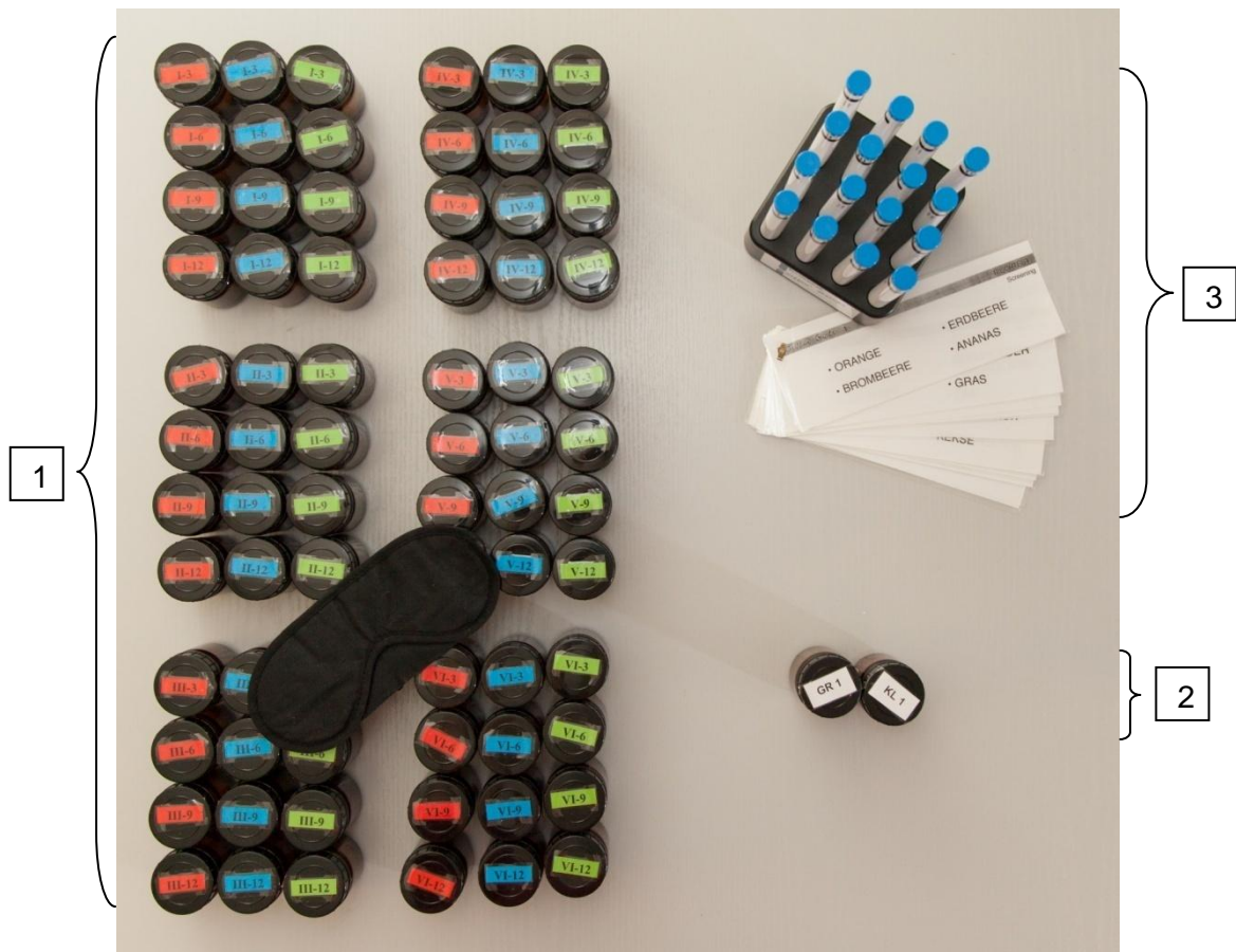
Abbildung 8: Versuchsaufbau erste Versuchsreihe 1: Schwellentestung; 2: subjektive Bewertung; 3: Identifikationstest
